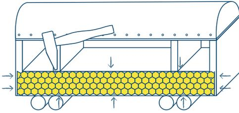
11. Das vorab mit dem Seitenschneider auf Maß geschnittene Drahtgitter ringsherum an der Holzkonstruktion festnageln.
