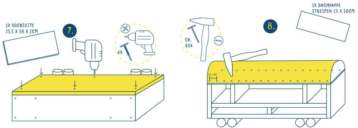
7. Holzkonstruktion auf Vorderseite ablegen. Brett für Rückseite passgenau rundherum mit 6–8 Schrauben montieren.
