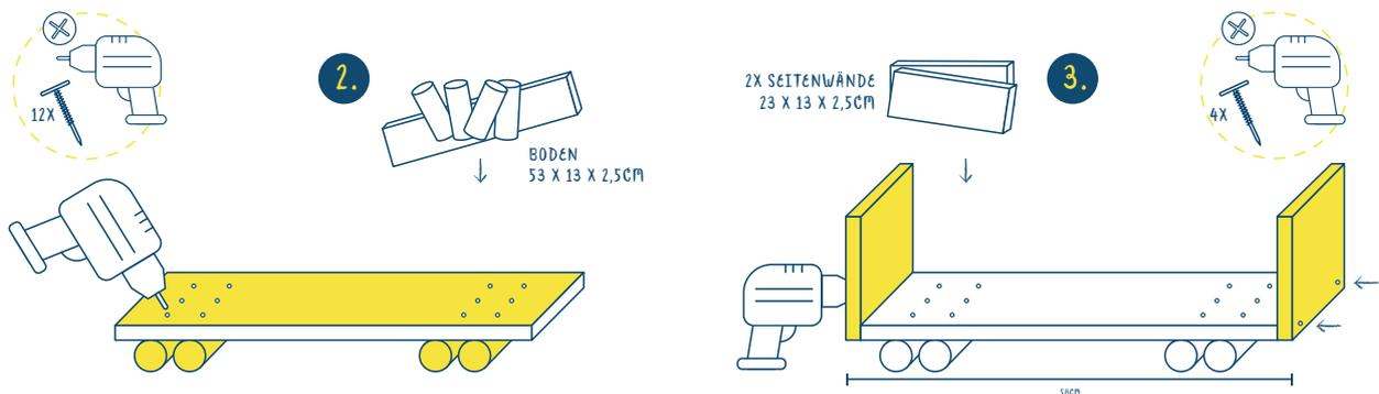
2. 4x Rundhölzer an die Unterseite des Bodenbretts mit je 2-3 Schrauben befestigen. Zuerst die beiden äußeren! Darauf achten, dass die Rollen vorne bündig sind! Den Überstand hinten braucht es später für Rückwand.
