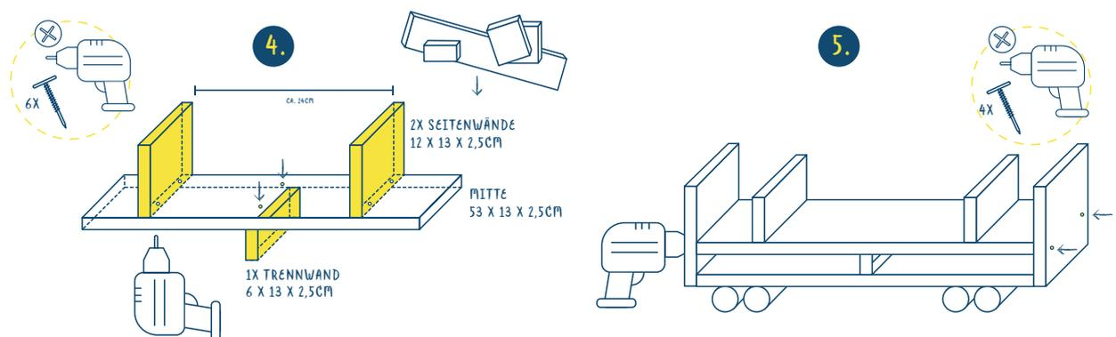
4. Die kleine Trennwand von oben mit je 2 Schrauben am Mittelbrett befestigen. Platzierung mittig! Brett wenden: Dann die 2 großen Trennwände mit je 2 Schrauben im Abstand von 12 cm zur Seitenkante am Brett montieren, sodass dazwischen genügend Platz (24 cm) für den Ziegelstein ist.
