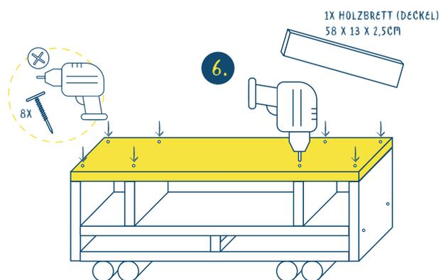
6. Deckel drauf: das längere Brett bündig auflegen, mit je 2 Schrauben von oben auf Seitenwänden den und Trennwänden befestigen.
