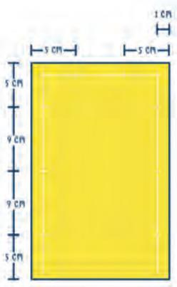
5. Ziehen Sie an 3 Seiten eine Linie mit 1 cm Abstand zum Rand und markieren Sie die **Bohrlöcher** wie auf dem Bild.
