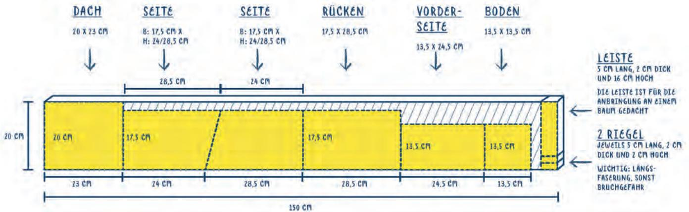
3. Bohren Sie auf der **Vorderseite** mit dem Forstnerbohrer-Aufsatz an der Markierung 1 Loch ( $\varnothing$  3cm). Danach die Ränder des Lochs sauber abschleifen.
